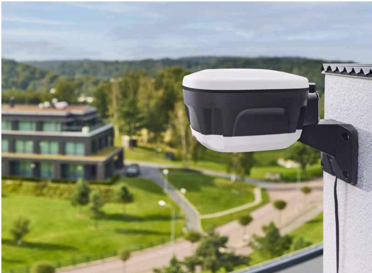
Le réseau privé d'AiConic est alimenté par une antenne de référence RTK, offrant un contrôle total sur votre système de tonte. En éliminant la dépendance aux réseaux tiers, vous assurez un fonctionnement ininterrompu tout au long de la saison, sans pannes externes. Le système offre une précision au centimètre près et prend en charge plusieurs robots de tonte simultanément, maximisant ainsi l'efficacité sans coûts de données récurrents.
